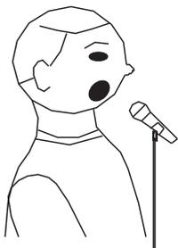
麦克风靠近声源,可以产生额外的低伴音效果,这种现象称为“近场效应”。利用这种效应可以使声音更加丰满.演奏乐器时,也可以利用近场效应来改善低音输出,而不必使用调音控制器。
